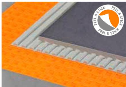
Schlüter-DITRA-PS представляет собой полипропиленовое полотно с квадратными углублениями в исполнении Easyfill, с самоклеящемся войлоком с обратной стороны. Подложка не пропускает воду. После снятия защитной пленки DITRA-PS можно укладывать на соответствующее основание без применения плиточного клея, то есть она служит в качестве разделительного и компенсирующего паровое давление слоя.
